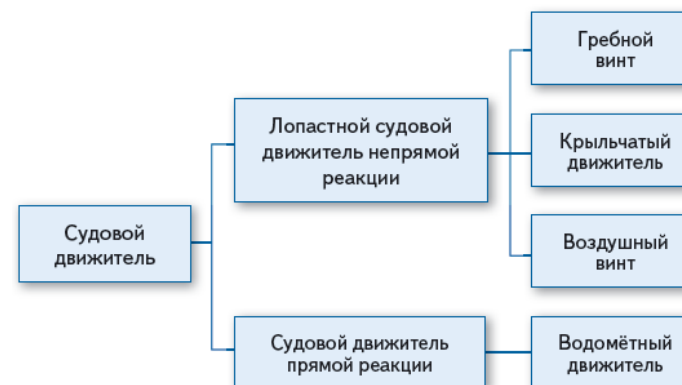
Рис. 78. Виды судового движителя
