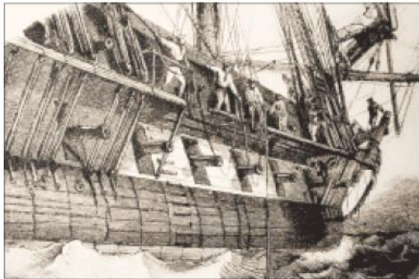
Рис. 97. Измерение глубины ручным лотом на парусном судне
